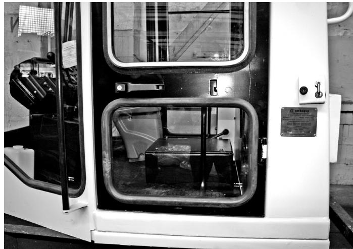
Рисунок 1.7 — Расположение маркировочной таблички кабины
