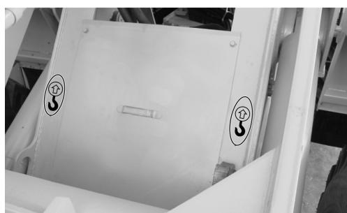
Рисунок 1.5 — Расположение знаков «Место строповки» на передней полураме
