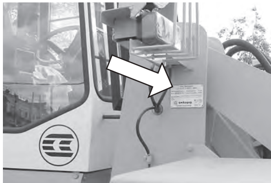
Рисунок 1.10 — Месторасположение маркировочной таблички
