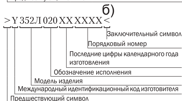
Рисунок 1.11 — Маркировочная табличка и её расшифровка:
