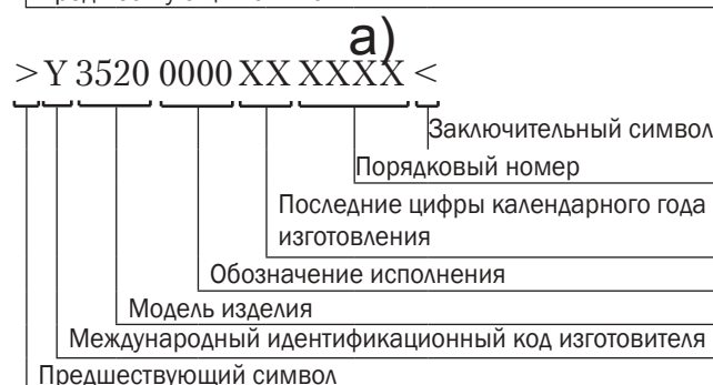
Рисунок 1.11 — Маркировочная табличка и её расшифровка:
