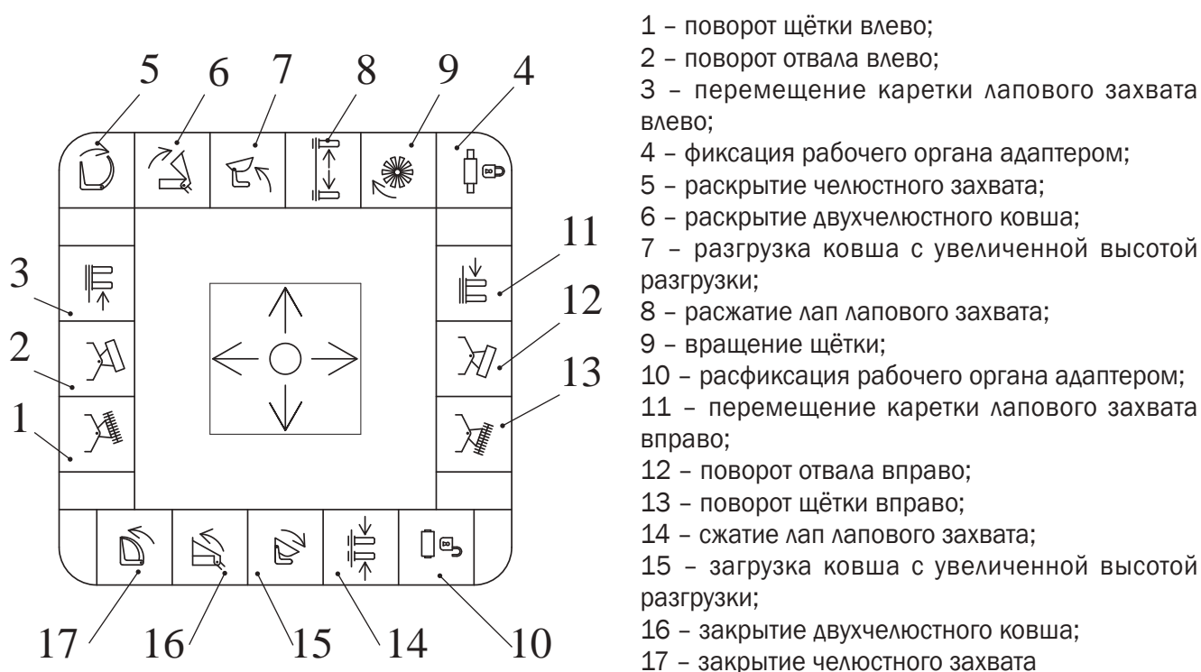
Рисунок 2.14 — Табличка управления рабочими органами погрузчика универсального
