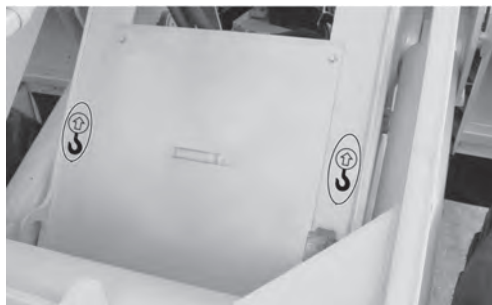
Рисунок 1.13 — Расположение знаков «Место строповки» на передней полураме
