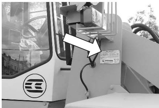
Рисунок 1.5 — Месторасположение маркировочной таблички
